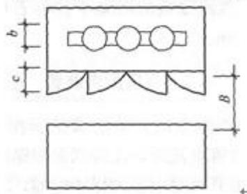
图 4.5.10—2 多台干式变压器之间 B 值
