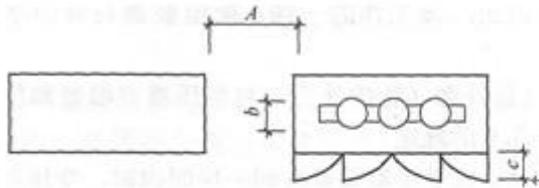
图 4.5.10—1 多台干式变压器之间 A 值
